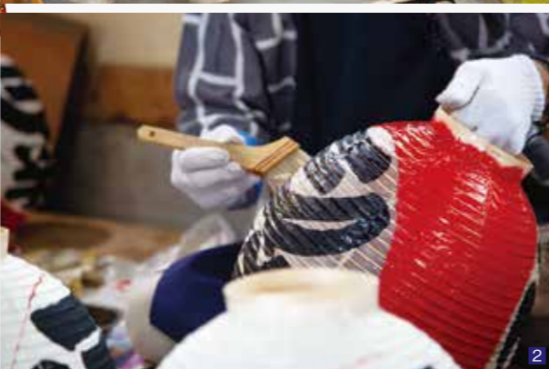
1 現在、に志たにの職人は友孝さんと公伸さんの2人。祭りの提灯づくりは分業で行う 2 文字を描き、色を塗った提灯は、油を塗って防水性を持たせる 3 久喜提燈祭りでは、提灯に本物のろうそくを灯す。その柔らかな光が魅力だ
