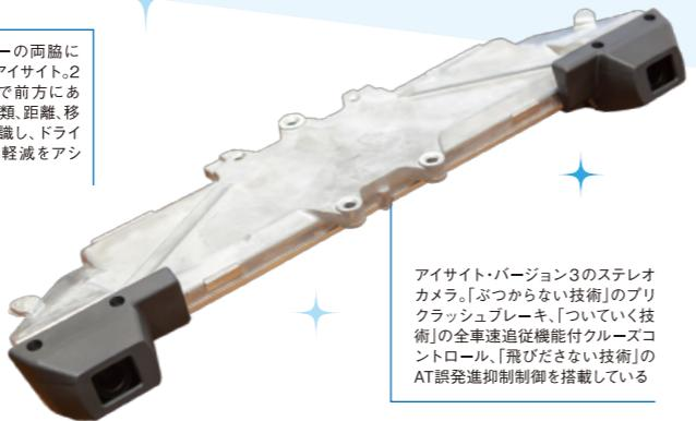
アイサイト・バージョン3のステレオカメラ。「ぶつからない技術」のプリクラッシュブレーキ、「ひいていく技術」の全車速追従機能付クルーズコントロール、「飛びださない技術」のAT誤発進抑制制御を搭載している
