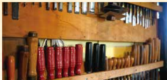
弦楽器づくりに欠かせない工具。削る場所や用途に合わせて使い分ける
