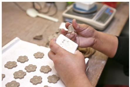
「かまもの」の商品「ひらたい桜」のデザイン画と、型押し成形をしているところ。ちょうどよい量の粘土を使い、しわができないように石膏の型に押し込みとり出すことで、桜の形が完成します
