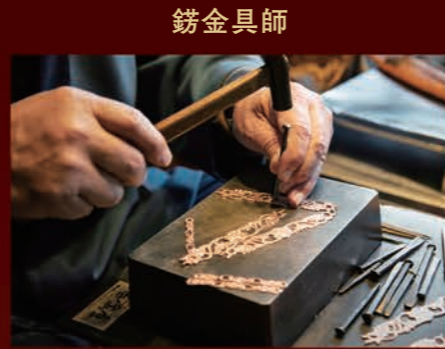
塗師：仏壇では木に漆を塗るところを銅板に。一領につき200枚以上の部品があるため、数をこなすのに一苦労だ。箔押し師：宮殿師が絶妙なバランスに仕上げた天衝に、箔押し師が丁寧に金箔を押ししていく。鮮やかな金色の天衝は朱色の胴体と並んで本作の主役といえよう。鍔金具師：武器を接合する紐を通すための留め金などを鍔金具師が制作。残念ながら改良版ではコストとの兼ね合いで省略された。
