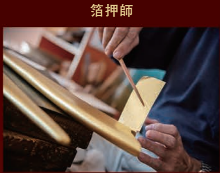
塗師：仏壇では木に漆を塗るところを銅板に。一領につき200枚以上の部品があるため、数をこなすのに一苦労だ。箔押し師：宮殿師が絶妙なバランスに仕上げた天衝に、箔押し師が丁寧に金箔を押ししていく。鮮やかな金色の天衝は朱色の胴体と並んで本作の主役といえよう。鍔金具師：武器を接合する紐を通すための留め金などを鍔金具師が制作。残念ながら改良版ではコストとの兼ね合いで省略された。
