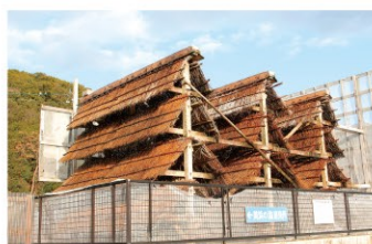
汲み上げた海水から、自然の太陽熱と風のみで濃縮塩水を作る「流下式枝条架」の施設。県下では唯一!塩づくり体験なども行っている。
