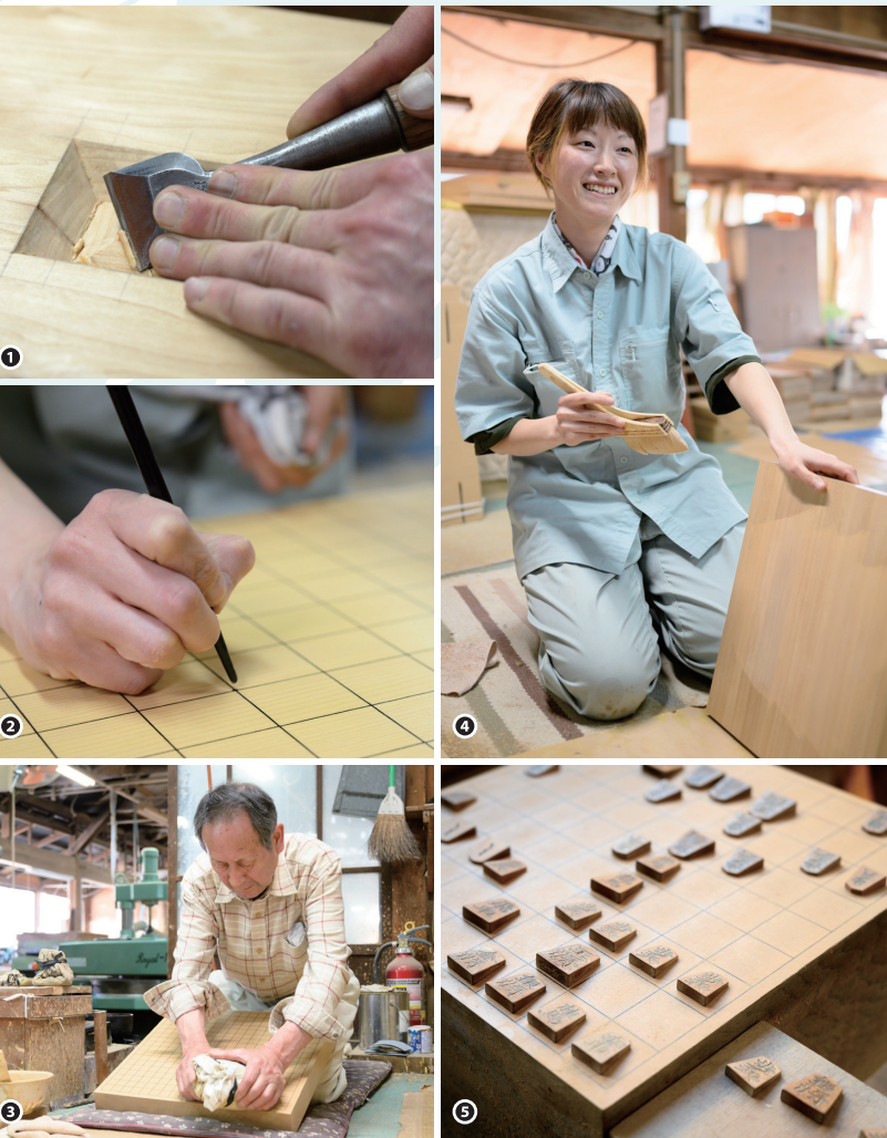
①将棋盤の裏にある「へそ」は逆ピラミッド型に掘られており、木の狂いを調整しながら、駒音を響かせる音響効果の2つの役割を持つ②盤面にある4つの点は「星」と呼ばれ、目盛りを引いた後に漆で丁寧に星を入れる③碁盤・将棋盤は、最後に溶かした蠟でコーティングを行う。この工程が独特の艶を出し、木の魅力を引き出す④同社初の女性職人である、職人歴1年の今野茜さん。「モノづくりの楽しさを日々感じています」と話す⑤昔から多くの日本人に愛されてきた将棋と囲碁。茨城木工はその大切な遊びを守る役割も担う
