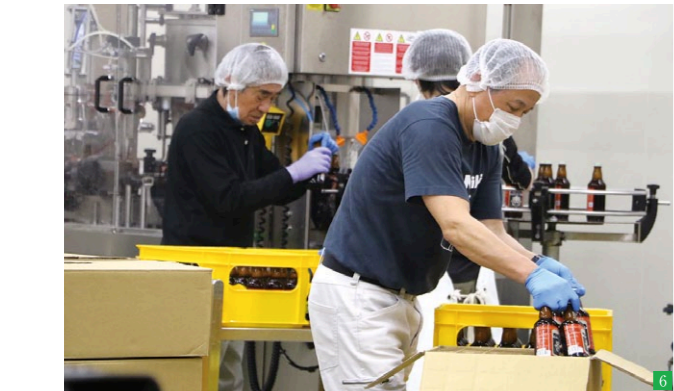
1.最新設備を備える下野工場。市内下野工場団地の一角に建設 2.貯蔵室で20種類以上のモルトを管理する 3.ロレック社の釜。破碎されたモルトが送られる糖化釜 4.世界中のビールコンペティションで金賞の常連となった「イセカド」のビール 5.事務所階段もコミュニケーションツールの一つ 6.瓶詰め工程。今後は缶ビールでの販売も展開する。消費者の利便性を考慮し、缶詰め可能な装置を新たに導入
