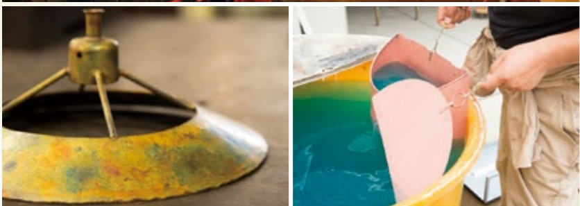
上) 改装を手がけ、クラフターを集めて立ち上げた尾賀商店 中右) 銅のポストを希硫酸液に浸けて下地を整える 中左) 銅をバーナーで炙った焼き色。虹のような色合いが人気を博す 右) アンティーク風の古銅色や白エッジング塗装など、住環境に合わせてカラーを提案する
