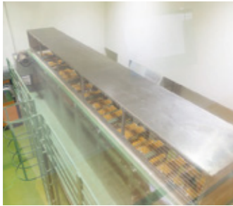
大きなファンで風を送り、揚げためんを冷やす工程。ちなみに工場内は一定の温度を保つよう空調管理されているそう。
