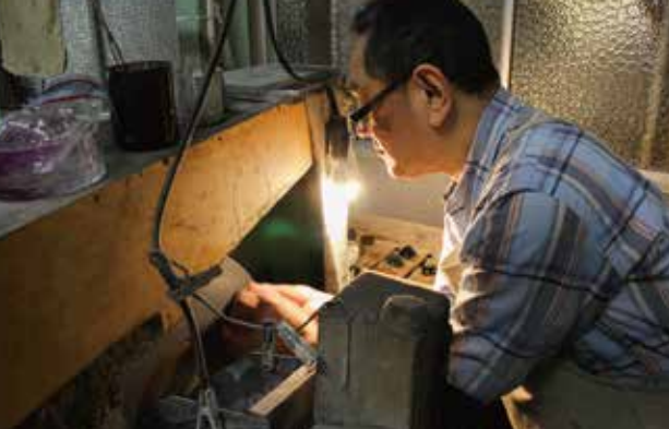
研磨機の側面で削っている様子。平切子の製法
