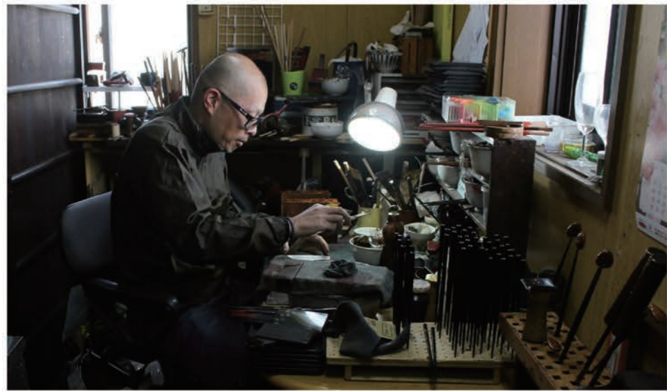
さまざまな道具を使い分ける若狭塗の作業場。包丁研ぎなどにも使われる大村砥などの天然砥石で研ぎ上げ、最終段階では木炭を使用する。箸は240、600、1000番台、2000番のペーパーで順次仕上げていく
