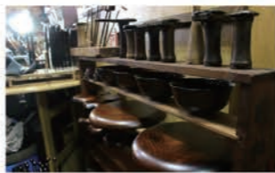
職人の工房内には、次の工程を待つ箸やトレー、椀など多彩な商品が並ぶ。全工程は20に及ぶだけでなく、塗り～乾燥に時間がかかるため、製作に1年かかる例も珍しくない
