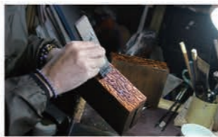
漆刷毛を使い、漆を塗り重ねては「室」(むろ)で乾燥させ、研ぎ、さらに塗って…の繰り返し。小さいころにかぶれた経験もある漆だが、今では仕事に不可欠なパートナーだ
