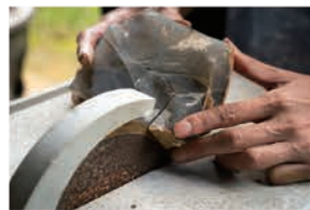
若狭めのう細工の工程は、原石の検石から始まり、大切り(カット)、野晒し(自然酸化)、焼入れ(酸化)と続く。上西さんの工房には焼入れ設備がない(今後、導入予定)ため、焼入れた原石の加工から始めることが多い
