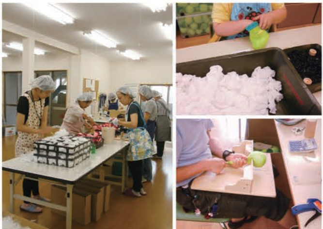
一つひとつのアカパックンに使う綿の量を測り、手作業で詰めています。治具を利用して両手で綿をきれいに入れる作業が続いています
