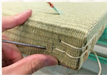
1枚の畳に使われるい草の本数は、畳の質によって4,000〜7,000本と異なる。打ち込み本数が多くなるほど上部で厚みのある良質な畳となる
