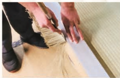
1枚の畳に使われるい草の本数は、畳の質によって4,000〜7,000本と異なる。打ち込み本数が多くなるほど上部で厚みのある良質な畳となる
