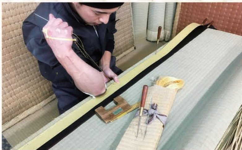
畳表や畳縁を縫い合わせるのには主に機械を使うが、要所で手縫いの技術も必要になってくる。職人の技術は現代でも必要不可欠だ
