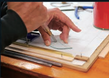
ガラスカッターを使い、各パーツをカットします。慣れない頃は、力加減が分からずガラスを割ってしまったことも
