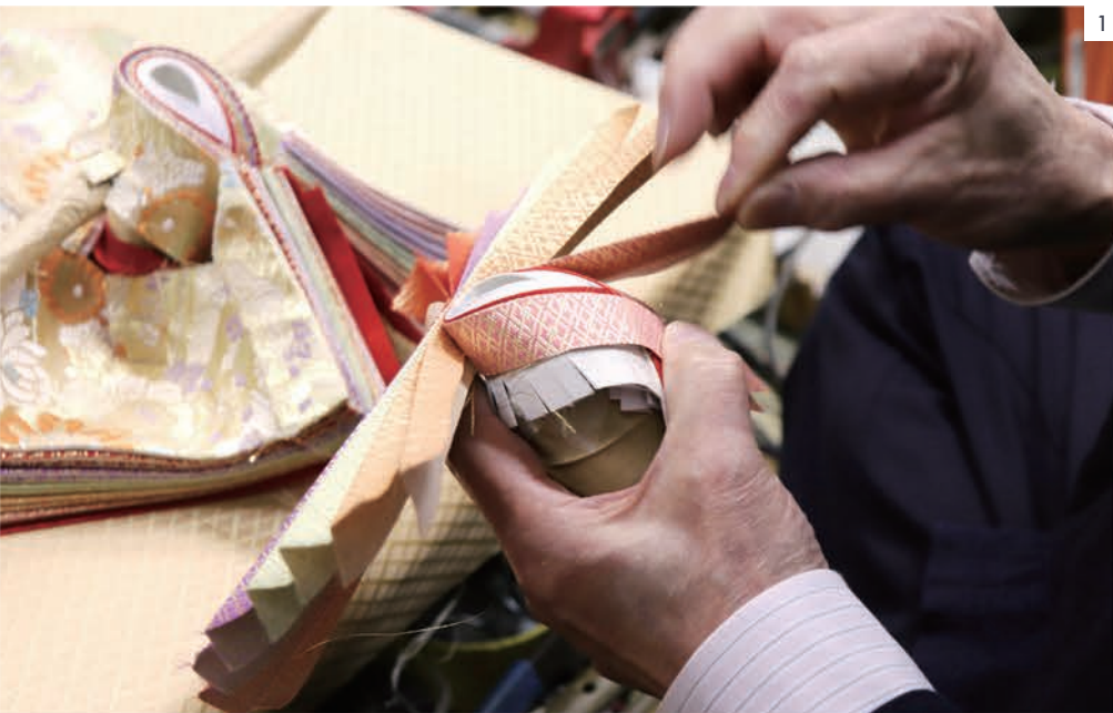
1. 藁を円柱状に固めた胴体部品に襟を一枚ずつ巻きつけ、着崩れないようしっかりと接着 2. 祝儀袋など、人形用の生地を使ったアイデア和小物も販売 3. 昔ながらの職業用本縫ミシンを使って縫製 4. 襟元の着付け、袴の装着、腕の肉付けが終わった状態 5. 襟布は、細い短冊のような状態に裁断して準備します 6. 工程ごとに並べた状態です
