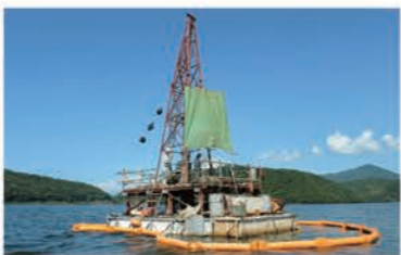
年縞をボーリング中のやぐら。2005年よりラムサール条約の指定湿地に登録されている、若狭国定公園の三方五湖。周辺では縄文時代の遺跡「鳥浜貝塚」が見つかっています。写真の水月湖は三方五湖の内の1つで、最も大きな湖（面積4.15平方キロメートル・水深34メートル）です（写真・山根一眞さん）
