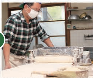
「かたパン」用に加工した製麺機で生地を均等に延ばす
