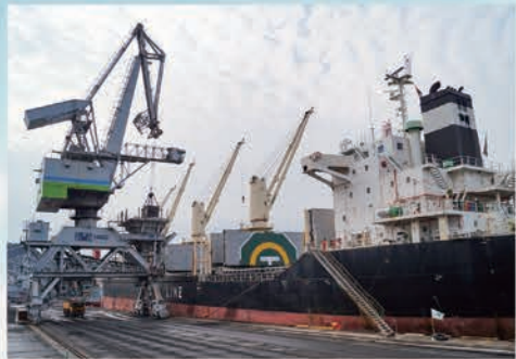
石炭船での作業に使われる多目的クレーン。地上約30mの高さに操縦席があります
