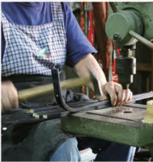
提灯弓製造の様子。曲げ、塗装をして最後にビスで止めて完成します
