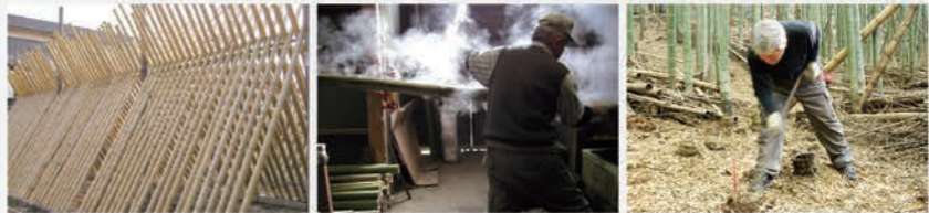
④春には所有する竹藪で筍を掘り、間引きます。傘を差して歩ける範囲で竹が生えているのが理想 ⑤熱湯に竹を一本ずつ入れ、湯抜き式で行う油抜き。水分を飛ばしてカビの発生を抑えることが目的です ⑥油抜きを終えた竹。2〜3カ月ほど冬の寒風にさらし水分を飛ばせば緑から白へと色が変わります
