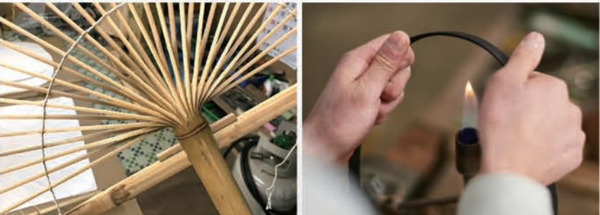
⑦ガスバーナーを用いる曲げ加工。発注元からの細かな要望に丁寧に応えます ⑧祭りで使われる巨大団扇。一本の竹を裂き、細かい骨をつかって左右に広げていきます
