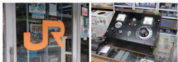
(左)店舗入り口に貼られた「JRマーク」は、実際に車両に付けられていたもの(右)鉄道模型を走らせる電源装置。家庭用AC(交流)100V電源を鉄道模型用DC(直流)へと変換する装置で、写真は先々代の忠雄さん手作り
